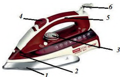
Расми 41. Дарзмоли барқӣ ва қисмҳои он: 1 – асос; 2- поя; 3 - танзими ҳарорат; 4- танзими бугдиҳӣ; 5-дастак, 6-ноқили барқӣ.
