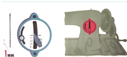
Расми 59. Танзимаи ҳаҷми кӯк ё лагандаи мошини дарздӯзии дастӣ
