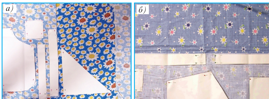
Расми 71. Тарзи гузоштани қолаб ба матоъ ва буридани нусхаи пешдоман: а) пешдомани яклухт бо рӯймол (сарбанд); б) пешдомани миёндор бо сарпӯш
