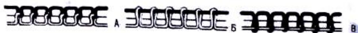
Расми 45. Дурусти чок: а – чоки дуруст; б – чоки нуқсондор (ресмони поён халта); в – чоки нуқсондор (ресмони боло халта)
